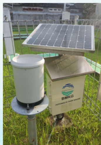
Gambar 3. Automatic Rain Gauge (ARG) dengan Sensor Tipping Bucket
